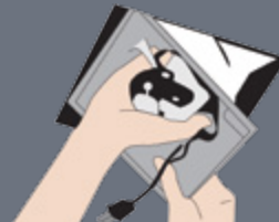
2. Remove old fan assembly
