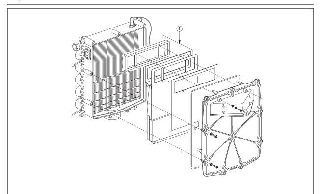
Fig. 32 : CHALLENGER Burner Components
