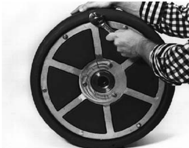
Figure 23 – Retrait du boulon de fixation de la queue de cochon
