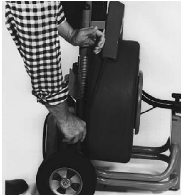
Figure 18 – Soulagement de la courroie
