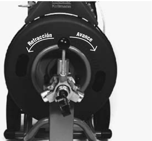
Figura 11 – Funcionamiento de la palanca del AUTOFEED
