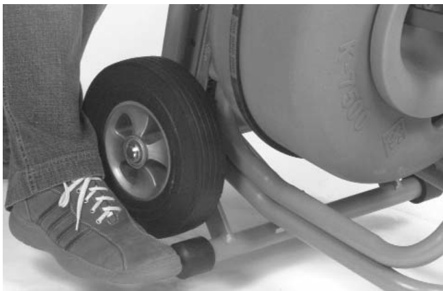
Figura 8 – Enganche de la barra apoyapiés en posición de trabajo
