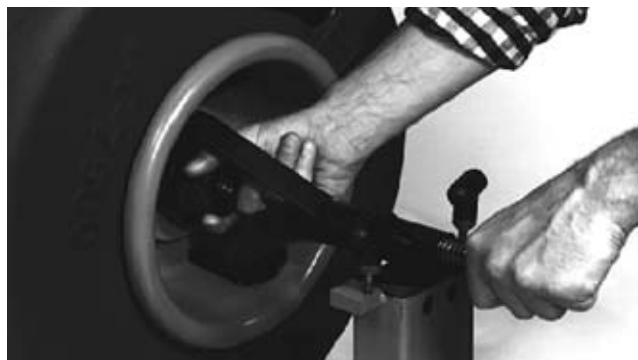
Figure 21 – Retrait de la manette de l'arbre central
