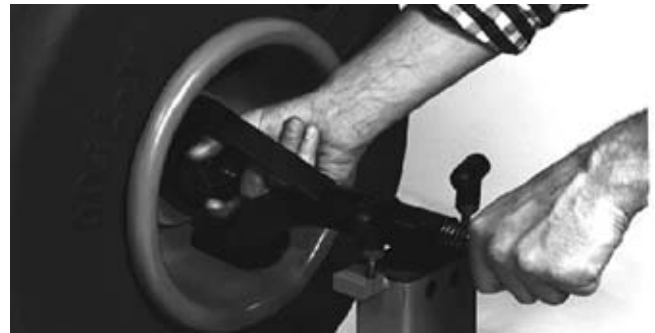
Figura 21 – Extracción de la perilla del eje central
