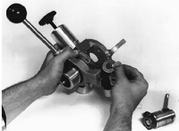
Figure 17 – Installer deux rondelles d'écartement pour câble de 5/8 po
