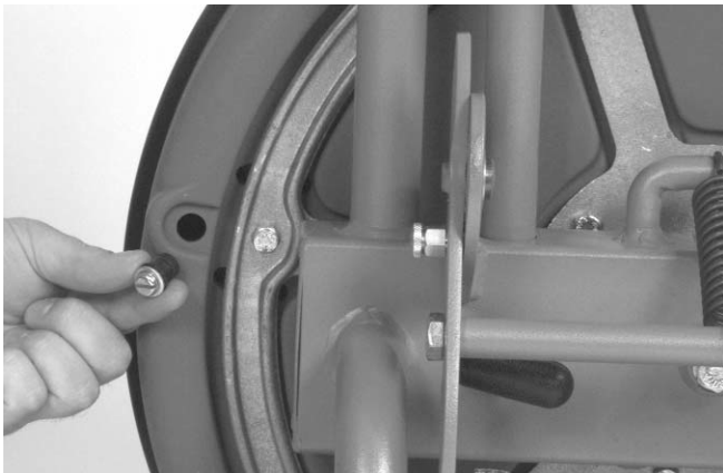
Figure 13 – Orifice de vidange du tambour
