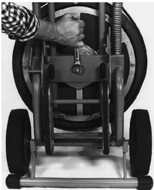
Figure 19 – Retrait du boulon du support arrière
