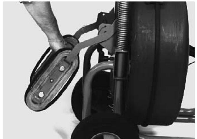
Figura 3 – Cómo levantar el trepaescaleras
