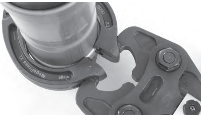
Figura 12 – Conexión del accionador al aro sellador
