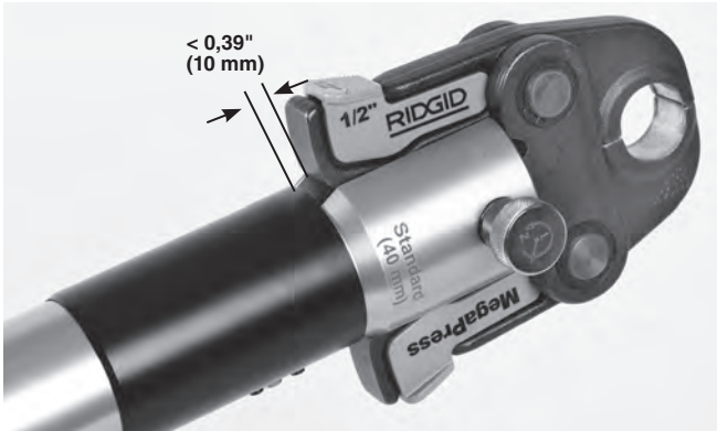
Figure 6B – Broche de montage complètement fermée
