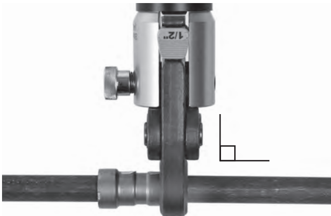
Figura 10 – Colocación correcta de las mordazas
