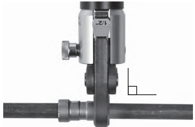
Figure 10 – Mâchoires en position appropriée
