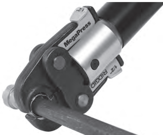
Figure 9 – Engagement des mâchoires autour du raccord
