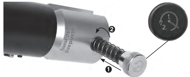
Figura 6 A – Retraiga completamente el pasador de montaje de accesorios
