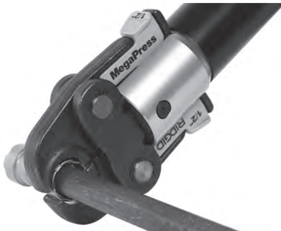
Figura 9 – Colocación de las mordazas para que encierren el acoplamiento
