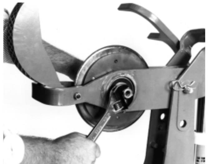
Figure 11 – Retrait de l'écrou de fixation
