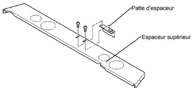
6. Mettez en place le support mural avec deux vis. Installez l'espaceur supérieur en insérant sa patte dans le support mural et en le fixant sur le chauffage avec 2 vis.
