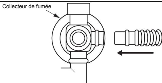
3. Adaptez la fermeture de tuyau sur le raccordement entre le coude de cheminée et le collecteur. Engagez le crochet et tournez-le jusqu'à ce qu'il s'enclenche contre le corps de l'étrier.
