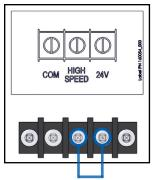
FOR CONSTANT HIGH SPEED CONTINUOUS OPERATION, INSTALL A JUMPER WIRE FROM THE 24 VAC TERMINAL TO THE HIGH SPEED TERMINAL.
