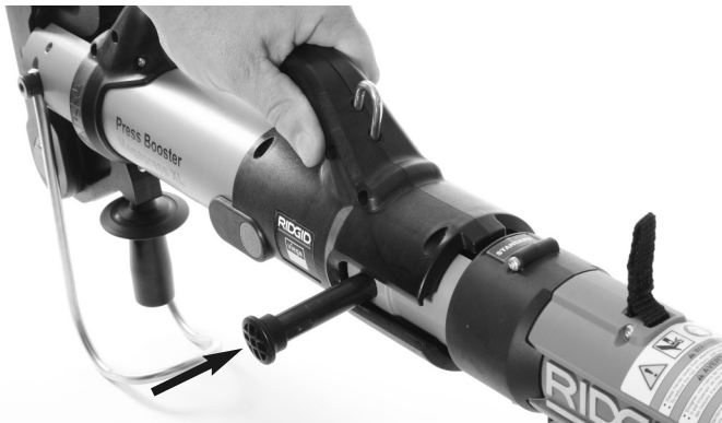
Figura 2 – Montaje del impulsor en la selladora
