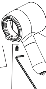
RP50465 Set Screw & Wrench Vis de Calage et Clé Tornillo de Ajuste y Llave
