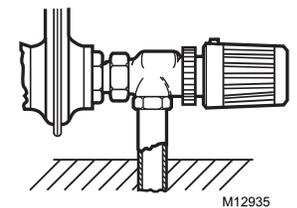
5. **Radiateur avec régulateur T104F** monté sur corps de vanne à angle V110E. Comme illustré, le radiateur était initialement installé près d'un coin, ou dans une alcôve, empêchant l'utilisation d'un régulateur monté horizontal. Le régulateur devant être monté verticalement, un modèle de capteur à distance T104F est requis, avec un capteur monté sur un mur à proximité avec une circulation d'air libre.
