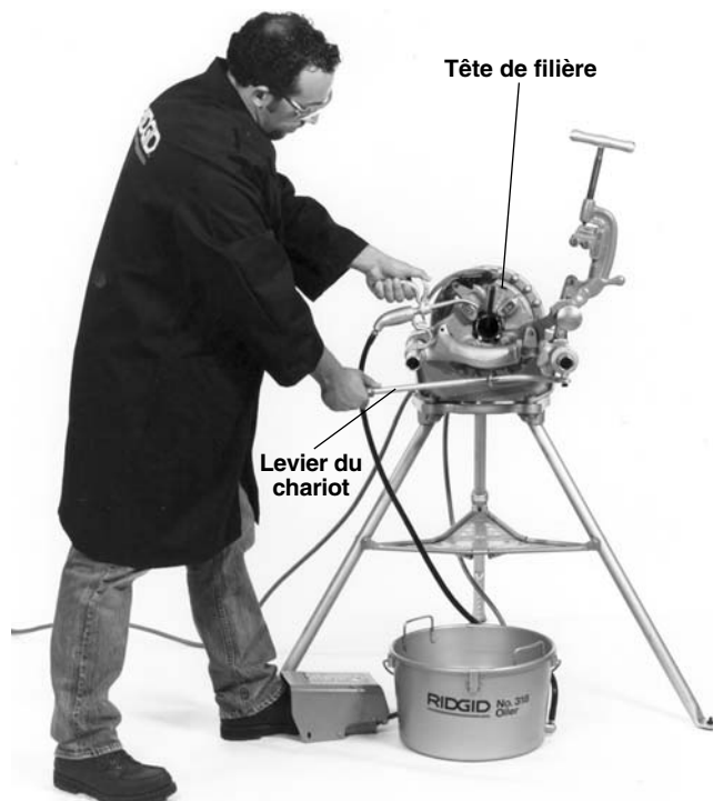
Figure 11 – Filetage des tuyaux à l'aide des fileteuses à ouverture rapide ou automatique.
