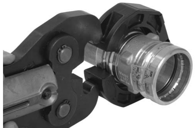
Figure 14A – Positionnement des embouts de mâchoire de l'actionneur dans les logements de la bague
