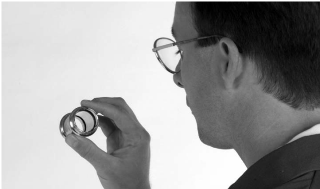
Figure 7A – Inspection d'un raccord ProPress selon les consignes du fabricant
