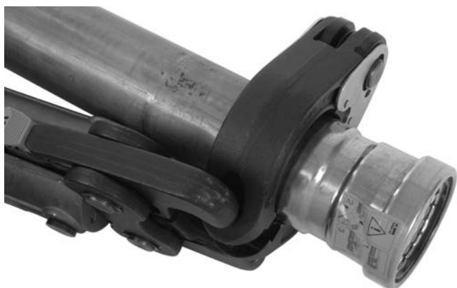
Figure 14C – Déviation de l'actionneur V2 dans les logements de bague XL-C pour faciliter l'accès
