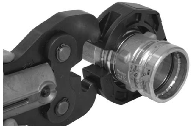
Figura 14A – Las puntas del accionador asentadas en las cavidades del aro
