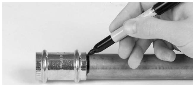
Figura 9 – Marque el tubo aún después de haberlo insertado hasta el resalte del acoplamiento
