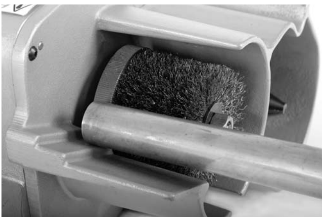
Figura 12 – Eliminación de rebabas del exterior del tubo
