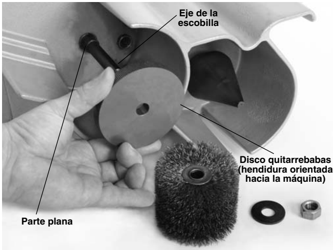
Figura 5 – Montaje del disco quitarrebabas
