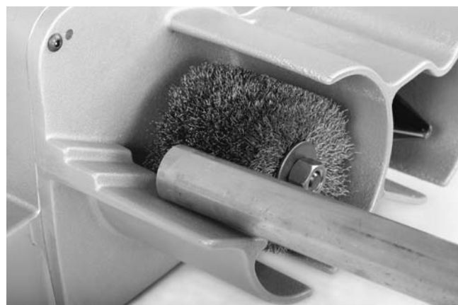
Figure 11 – Nettoyage externe du tube
