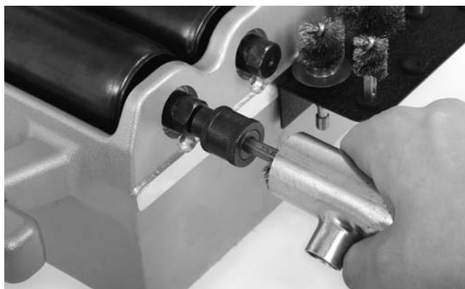
Figura 14 – Limpieza del interior de un acoplamiento
