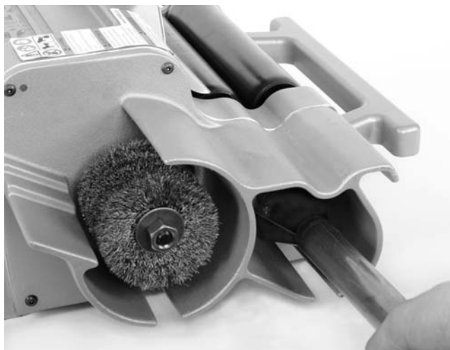
Figura 13 – Escariado del interior del tubo
