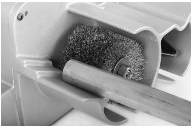
Figura 11 – Limpieza del exterior del tubo
