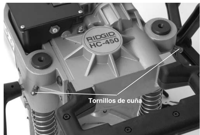
Figura 13 – Ajuste de los tornillos de cuña
