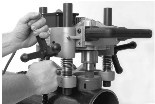
Figure 11 – Utilisation de la scie à cloche
