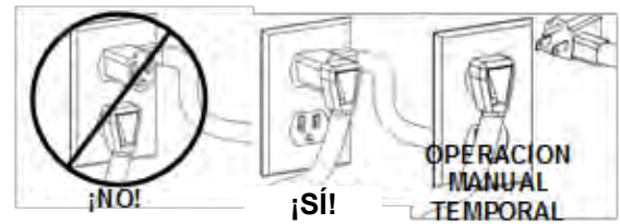
Figura 4 Instalación del enchufe en cascada
