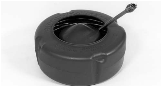
Figura 21 – Enrolle el cable dentro del tambor interior en el sentido contrario al de las manecillas del reloj
