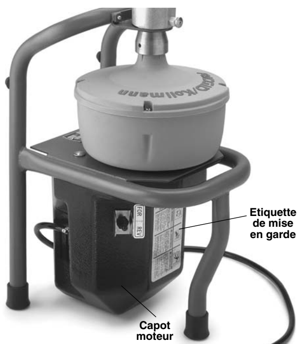
Figure 7 – Etiquette de mise en garde du K-40
