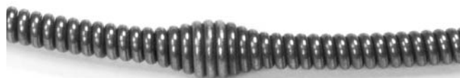
Figure 12 – Câble C-13-IC équipé du témoin de fin de course Speed Bump à environ 84 pouces de l'extrémité arrière du câble
