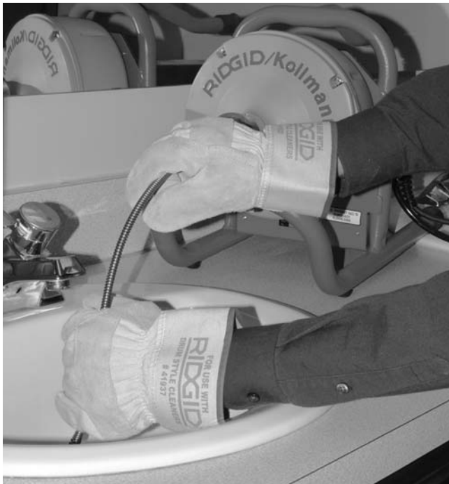
Figura 11 – Alimentación del cable en forma manual
