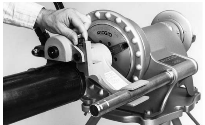
Figure 10 – Desserrage de la vis de réglage de profondeur
