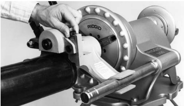
Figura 10 – Afloje el tornillo de regulación de la profundidad
