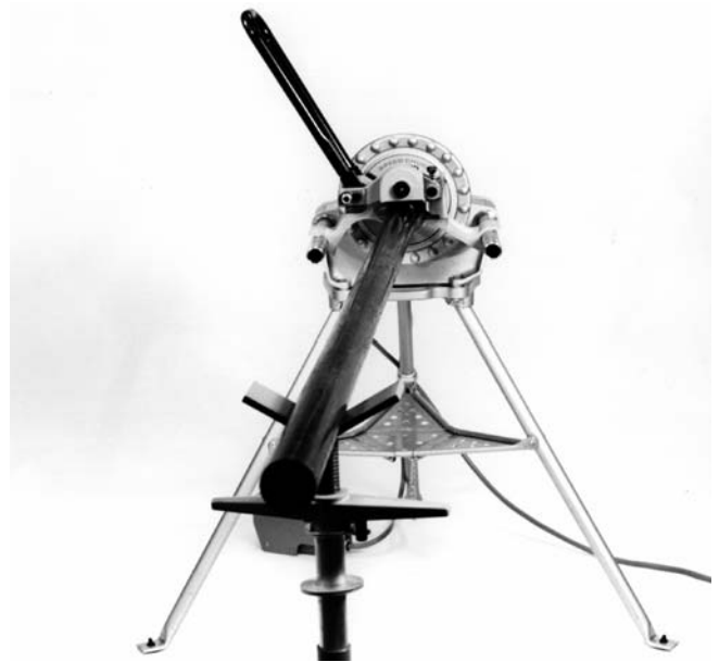
Figure 8A – Desvío del tubo cuando la fuente de accionamiento marcha en REVERSA (REV)
