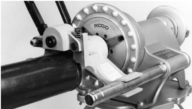
Figura 9 – Mango de alimentación en posición UP (arriba).
