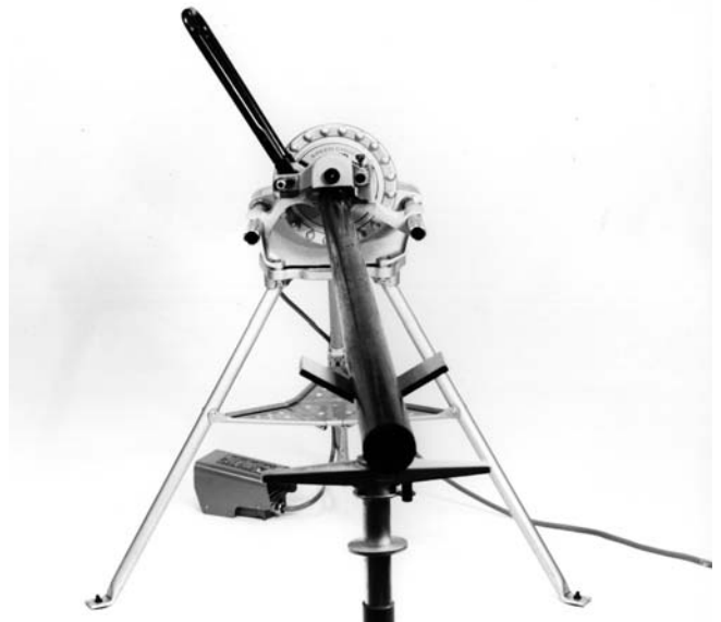
Figura 8B – Desvío del tubo cuando la fuente de accionamiento marcha hacia delante (FOR)
