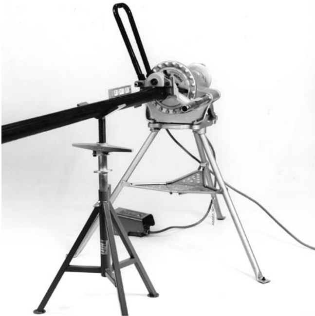
Figura 7 – Nivelación del tubo
