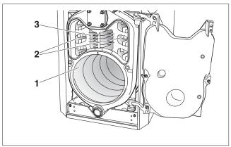
Fig. 67 Open the burner door
