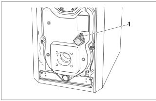
Fig. 60 Pressure test port on burner door
