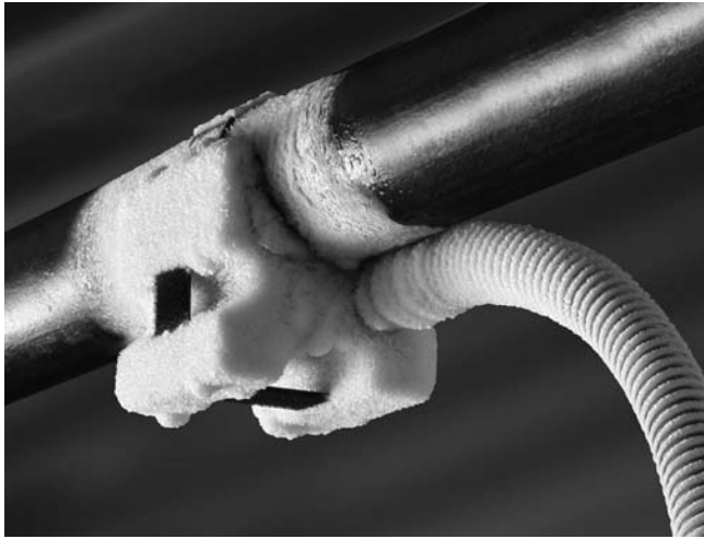
Figure 9 – Tête de congélation et tuyau gelés
