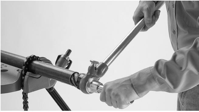
Figure 4 – Alésage de l'extrémité du tuyau
