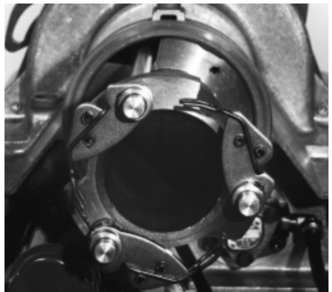
Figura 21 – Portaherramientas dispuesto para funcionar a mano izquierda (se han sacado los clips en E y retenes para mayor claridad)
