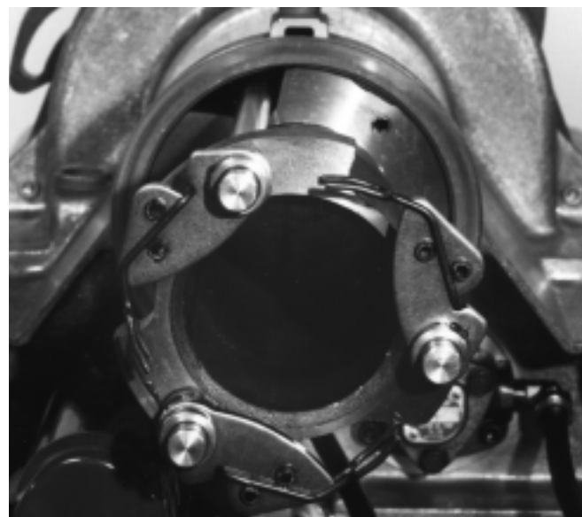
Figure 21 – Système de mandrinage de la machine configuré pour rotation à gauche (cerclips et crampons retirés pour raisons de clarté)
