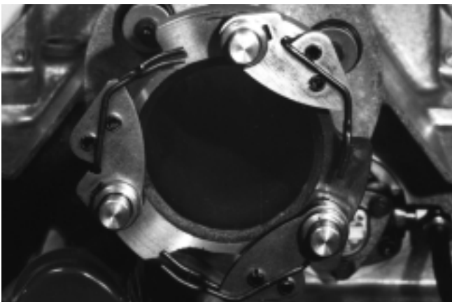
Figura 24 – Vuelva a instalar las mordazas traseras y los espaciadores en las varillas
