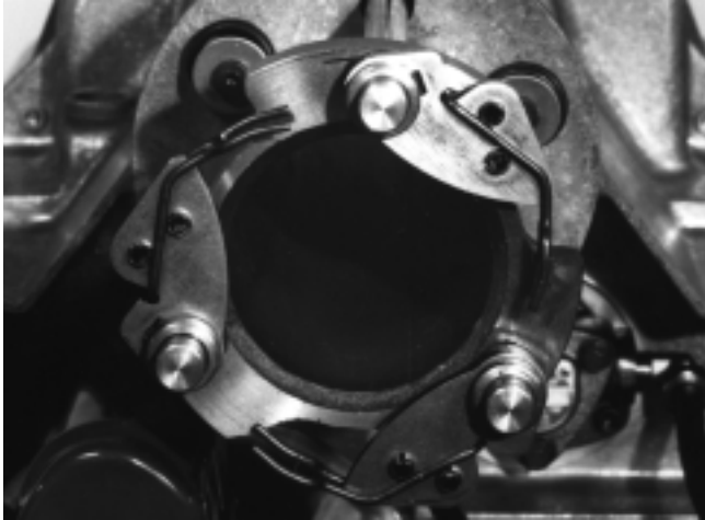
Figure 24 – Réinstallation des mâchoires arrières et des cales d'écartement sur les axes
