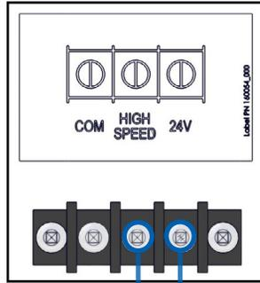
FOR CONSTANT HIGH SPEED CONTINUOUS OPERATION, INSTALL A JUMPER WIRE FROM THE 24 VAC TERMINAL TO THE HIGH SPEED TERMINAL.
