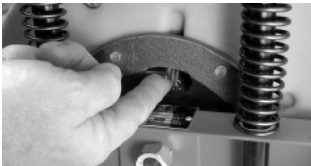
Figura 4 – Levante el pasador de desenclavamiento hacia ARRIBA para soltar el mecanismo de enganche para el tambor.
