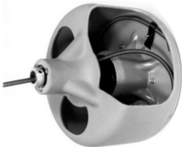
Figura 5 – Enrolle el cable en el tambor tal como se muestra (el recorte del tambor solamente se ha efectuado para propósitos de ilustración)
