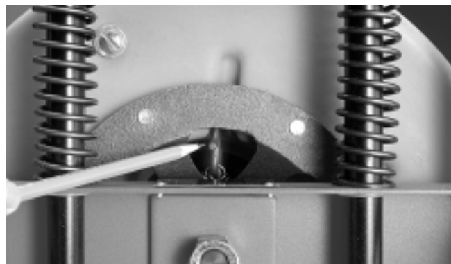
Figura 3 – Gire el tambor para que el pasador de enclavamiento sea fácilmente accesible.
