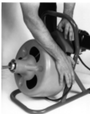
Figura 2 – Con la tensión de la correa soltada deslízcala para sacarla del tambor
