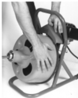
Figura 1 – Empuje sobre el motor para soltar la tensión del resorte sobre la correa
