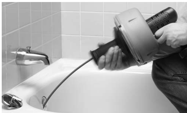
Figura 5 – Mueva la empuñadura hacia la máquina para enganchar el embrague
