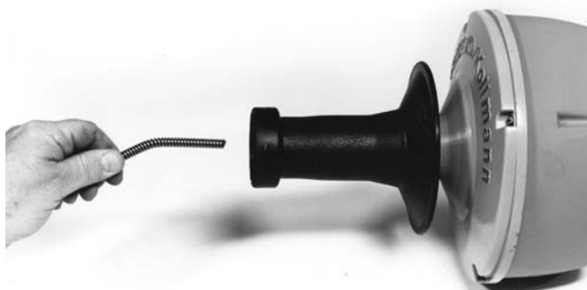
Figura 11 – Cómo meter cable suelto en el tambor
