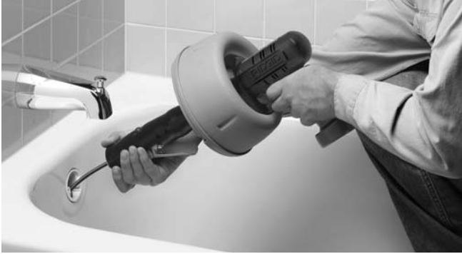
Figura 8 – Deje una distancia de 6 pulgadas o menos entre el acceso al desagüe y la nariz de la máquina limpiadora
