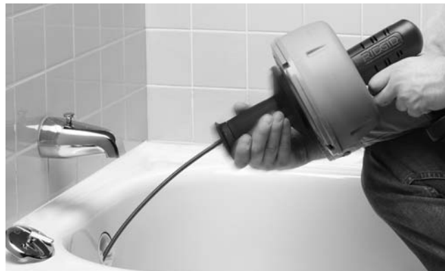
Figure 5 – Tirez la poignée en arrière pour engager l'embrayage
