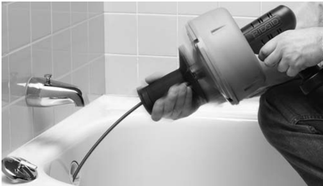
Figure 7 – Poussez la poignée en avant pour désengager l'embrayage et retirer du câble supplémentaire du tambour
