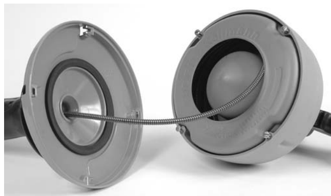
Figura 10B – Pase el cabezal del cable expuesto a través de la tapa delantera del tambor y vuelva a ensamblar el tambor
